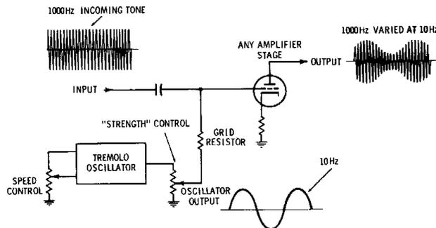
Fig. 2-6. Tremolo circuit.
